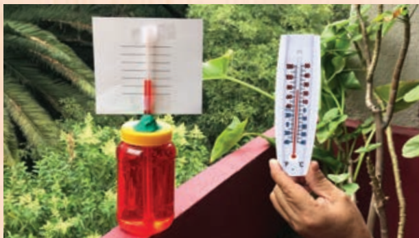
Figura 1.93 Con un termómetro casero y una regla puedes medir la temperatura de diferentes objetos.
