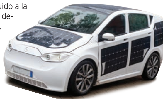
Figura 2.87 Los autos solares cuentan con un panel que capta la energía del sol para transformarla en movimiento.
