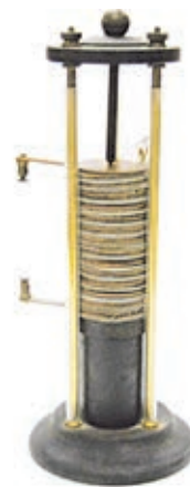
Para construir la primera batería de la historia, Volta utilizó disoluciones ácidas.
