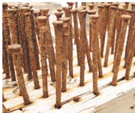
La oxidación de un clavo es un cambio químico que ocurre porque el hierro del que están hechos y el oxígeno del aire reaccionan formando óxido de hierro.
