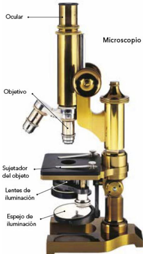
El microscopio óptico funciona con varias lentes que sirven para amplificar objetos muy pequeños o que no se pueden observar a simple vista (objetos microscópicos).
