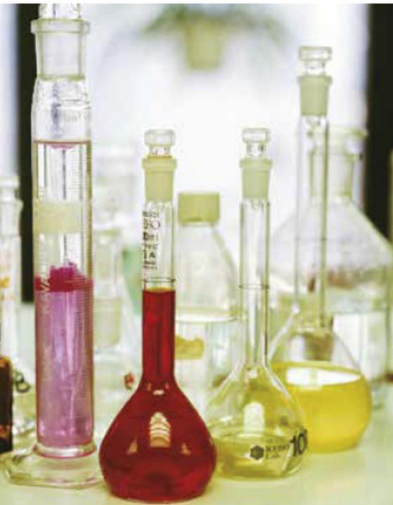
Material para medir volúmenes en el laboratorio: probeta y matraces.
