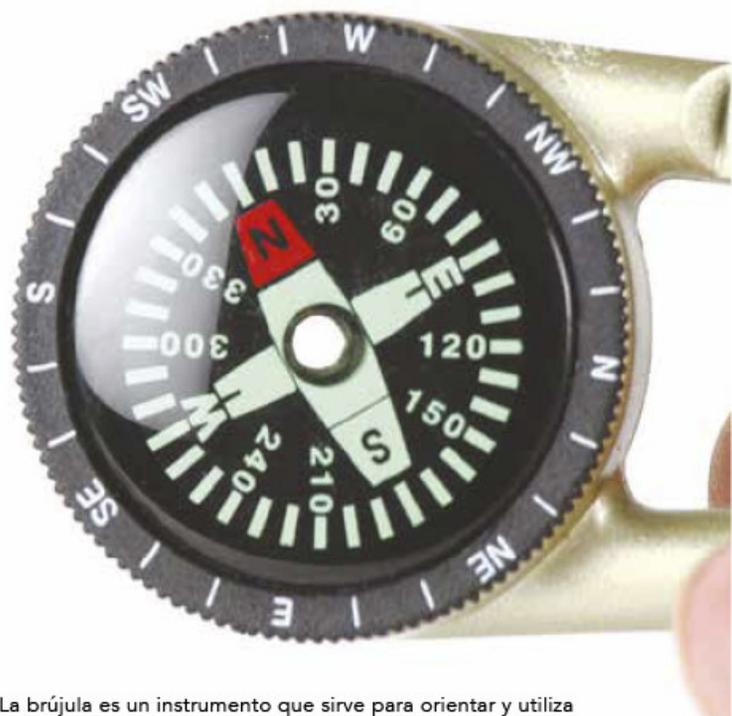
La brújula es un instrumento que sirve para orientar y utiliza el magnetismo para su funcionamiento. La aguja siempre señala el norte magnético de la Tierra.
